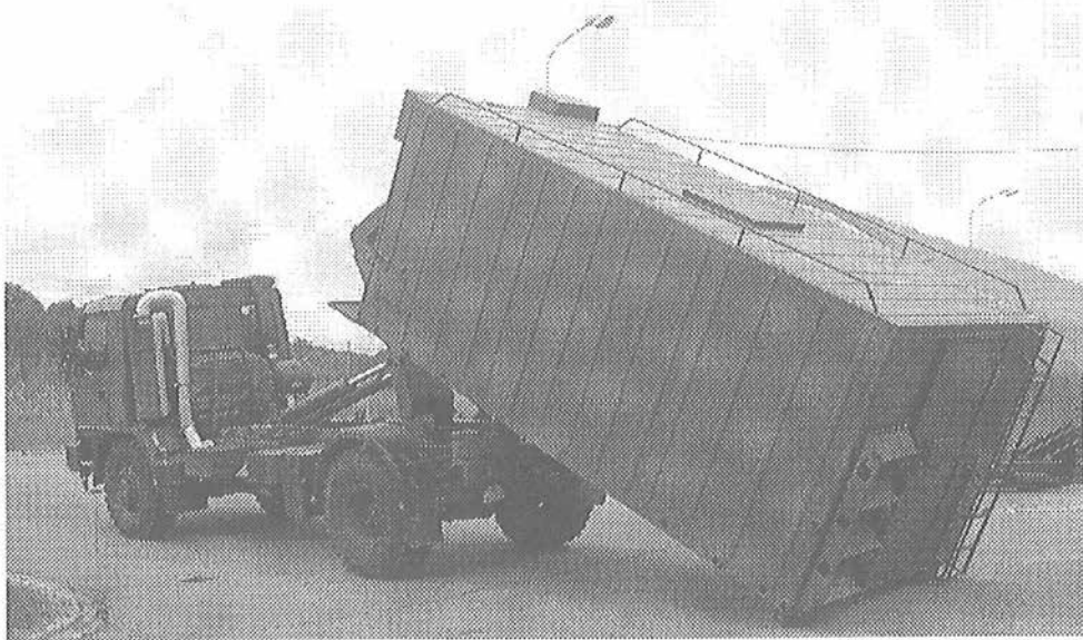
Obr. 2. Kontejnerová střední skříňová sendvičová karoserie
