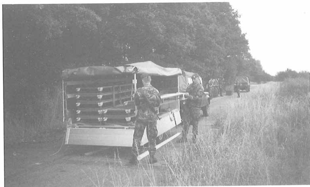
Obr. 1. Skládání lávky z přívěsu
