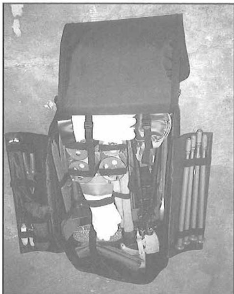
Obr. 3. Uložení pomůcek ve vaku pro průzkum zátarasů
