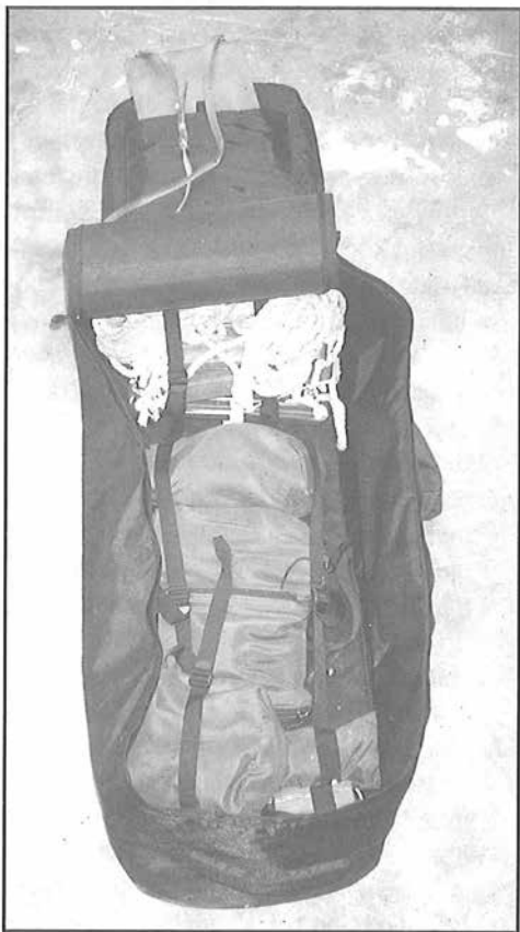
Obr. 2. Uložení pomůcek ve vaku pro průzkum terénu a objektů
