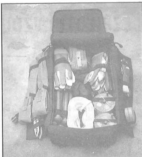
Obr. 9. Celkový pohled na uložení soupravy pomůcek družstva pro odminování ve vacích nové konstrukce
