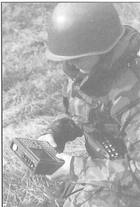
Obr. 4. Datový terminál DICOM DT 13 slouží ke sběru, přenosu a zpracování nejrůznějších informací přímo v terénu. Jeho součástí je přijímač GPS
