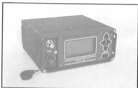
Obr. 3. Přijímač DICOM GPR 24 je určen především k zástavbě do mobilních prostředků. Prostřednictvím datové sběrnice může být připojen do palubního elektronického systému
