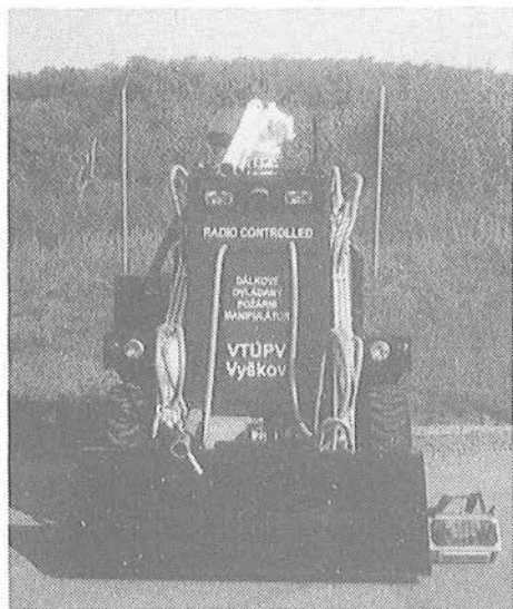
Obr. 1a. Umístění elektrického lanového navijáku na rámu stroje a proudnice na lopatě (impulzní hasicí zařízení a práškový hasicí přístroj). Na zemi ovládací panel obsluhy. (Čelní pohled.)
