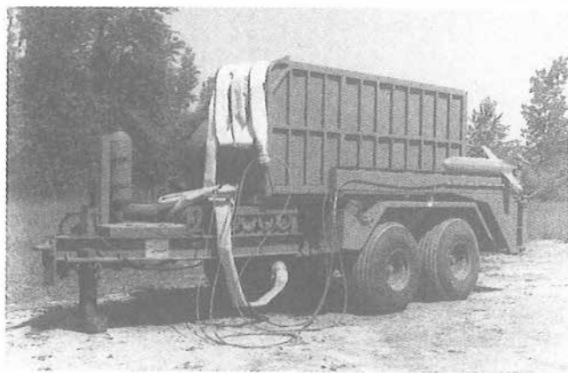
Obr. 8. Kanadský odminovací systém FALCON měl odstranit problémy s navazováním průchodu v minovém poli
