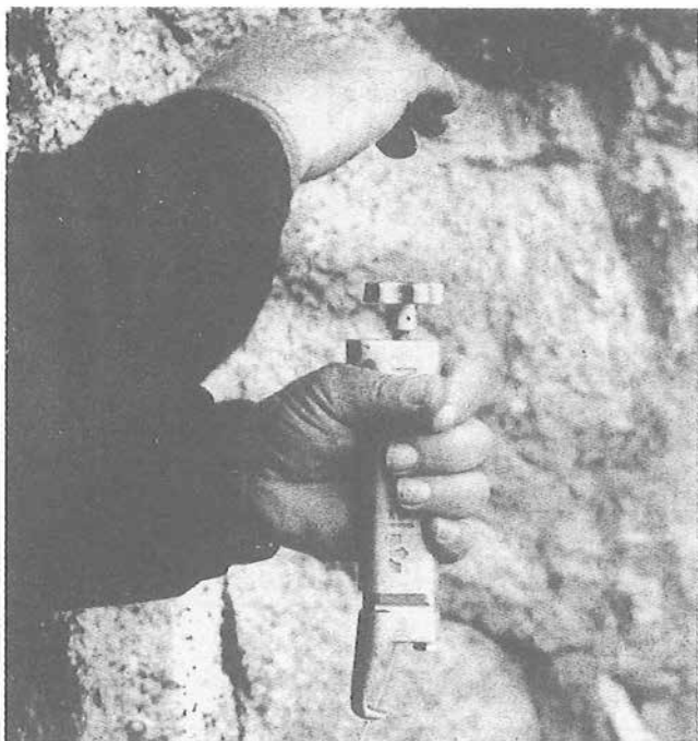
Obr. 3. Iniciace systému NONEL pomocí startovací pistole
