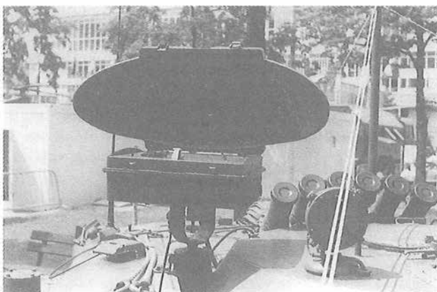
Obr. 3. Radiolokátor PSNR-5 z průzkumného systému v pracovní poloze na věži vozidla
