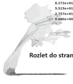
Obrázek č. 3: Simulace rozletu střepin z pletiva při použití páskové plastické trhaviny
