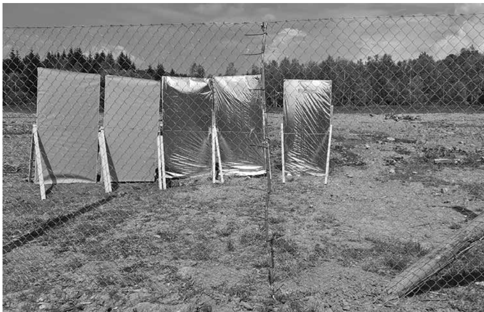
Obrázek č. 6: Fence charge sestavená z bleskovice
