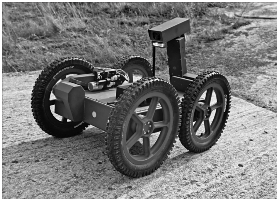
Obr. 5: Průzkumný robot speciální chemické nástavby vozidla LOV-CBRN.
