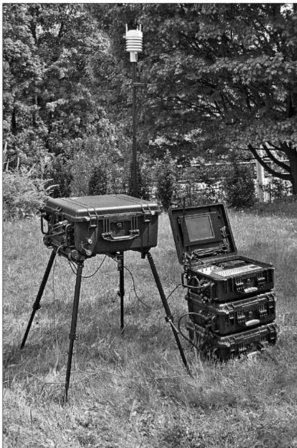
Obr. 6: Sestava zařízení výnosného CBRN monitorovacího modulu.
