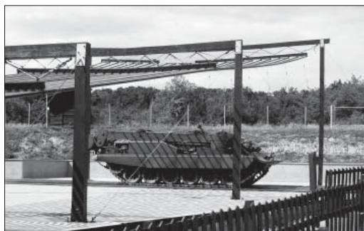
Obr. 8: Pracoviště simulátoru NEMP (nukleárního elektromagnetického impulzu)
