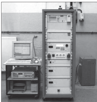
Obr. 3: Pracoviště zkoušek odolnosti proti poklesům a výpadkům napájecího napětí, změn kmitočtu, pomalých změn napětí, měření harmonických a kolísání napětí
