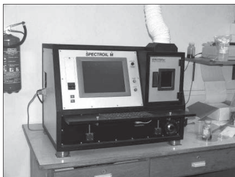
Obr. 18: Atomový emisní spektrometr s rotační diskovou elektrodou SPECTROIL M pro AES/RDE spektroskopii
