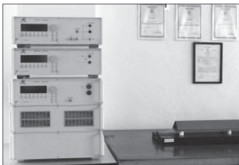
Obr. 7: Část pracoviště pro provádění zkoušek elektromagnetické kompatibility na elektrických a elektronických komponentech motorových vozidel
