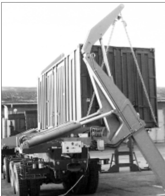
Obr. 4: Boční překladač KLAUS-STEELBRO SB 30
