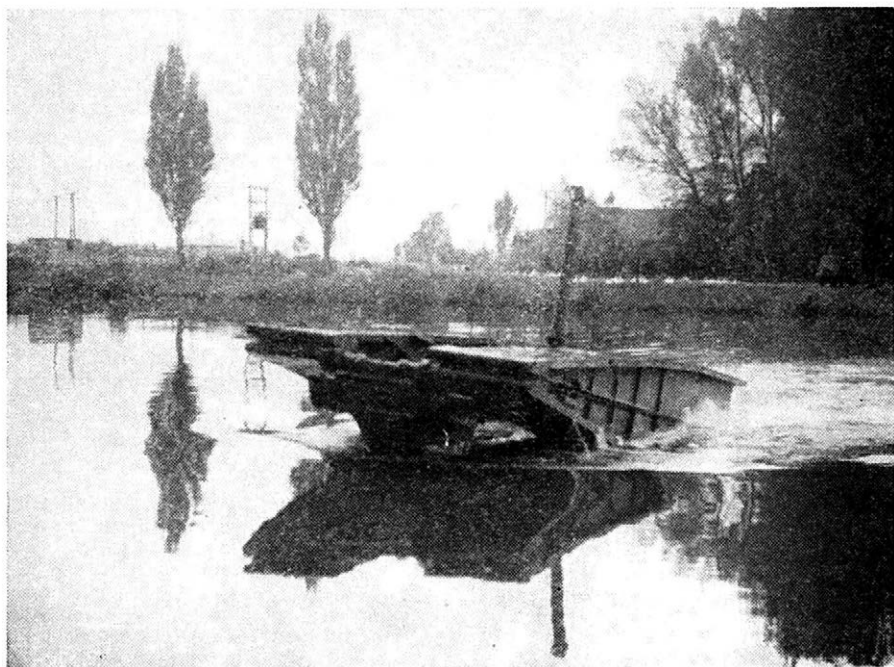
Obr. 1. Mostní tank MT-55A při výjezdu z podvodního přepraviště
