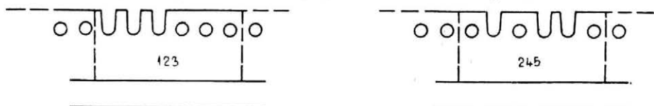
Obr. 1 b: Princip číselného kodu 4 a 5 skupiny centrálního třídění informací
