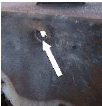
Zásah bočního pancíře z RPTZ RPG-75 (došlo k výbuchu kumulativní hlavice – pancíř probit)
