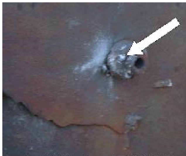
Zásah bočního pancíře z RPTZ RPG-75 (došlo k výbuchu kumulativní hlavice – pancíř neprobit)
