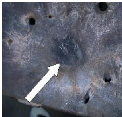
Zásah bočního pancíře z RPTZ RPG-75 (došlo k rozbití kumulativní hlavice – pancíř neprobit)
