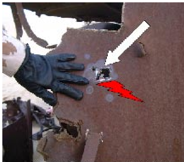
Zásah bočního pancíře z RPTZ RPG-75 (došlo k výbuchu kumulativní hlavice – pancíř probit)
