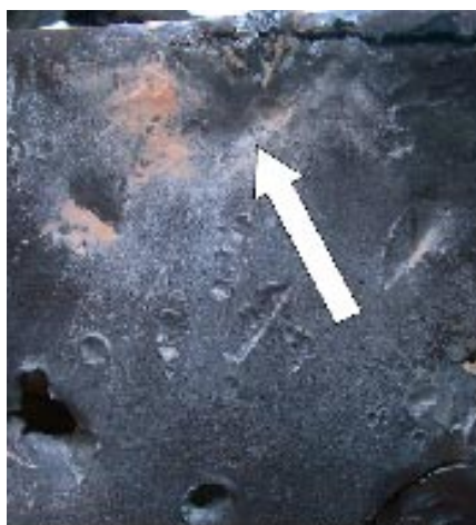
Zásah bočního pancíře z RPTZ RPG-75 (došlo k rozbití kumulativní hlavice)
