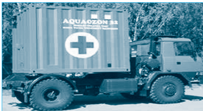
Obr. 3: Úpravna pitné vody AQUAOZON 32
