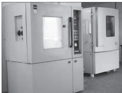
Obr. 6: Část pracoviště pro provádění zkoušek vlivu prostředí (chlad, suché teplo, vlhkost)
