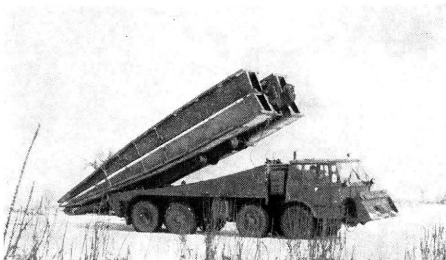
Obr. 4: Překlápění mostu v počáteční fázi přemostování překážky
