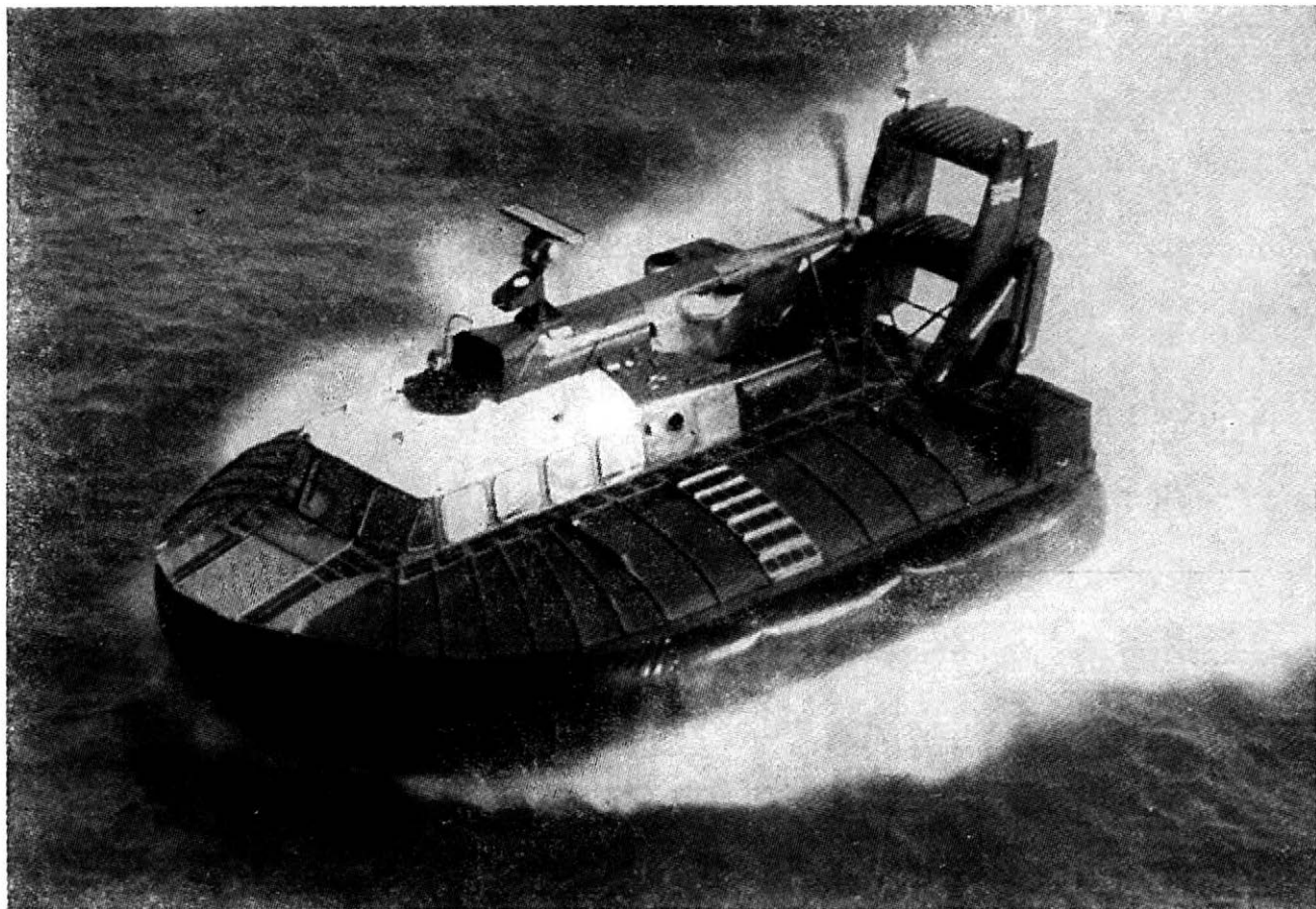
Obr. 2: Vznášedlo, opatřené pružnými závěsy, v jízdě
