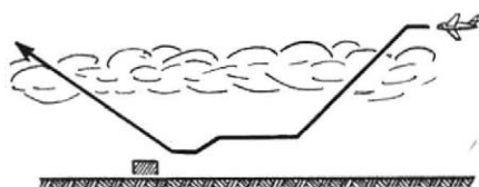
Obr. 23. Průzkumný let za ZPP (ztížených povětrnostních podmínek) provedením neřízeného sestupu přes souvislou pokrývku mraků (v rovinatém terénu při známé výšce spodní základny mraků)
