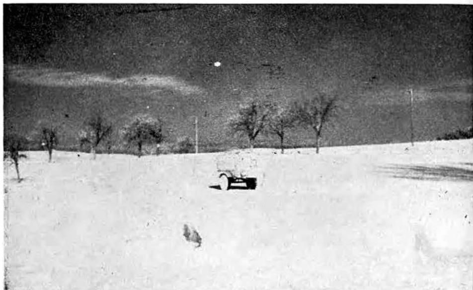
Obr. 6. Infrasnímek kompresoru opatřeného infranátěrem
