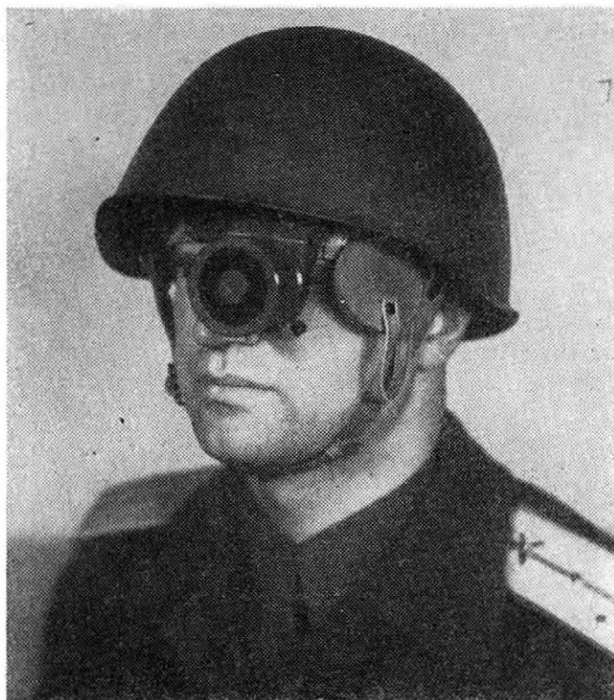
Obr. 8. Infraprůkazník pro pozorovatele (detektor) při použití
