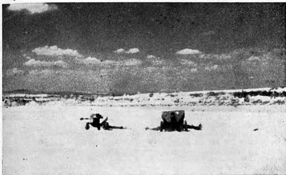
Obr. 2. Infrasnímek dvou kanonů. Levý kanon opatřen maskovacím nátěrem
